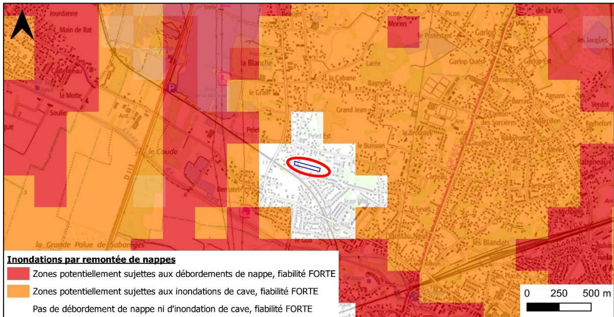
***Extrait de la cartographie du risque de remontée de nappes établie par le BRGM***
