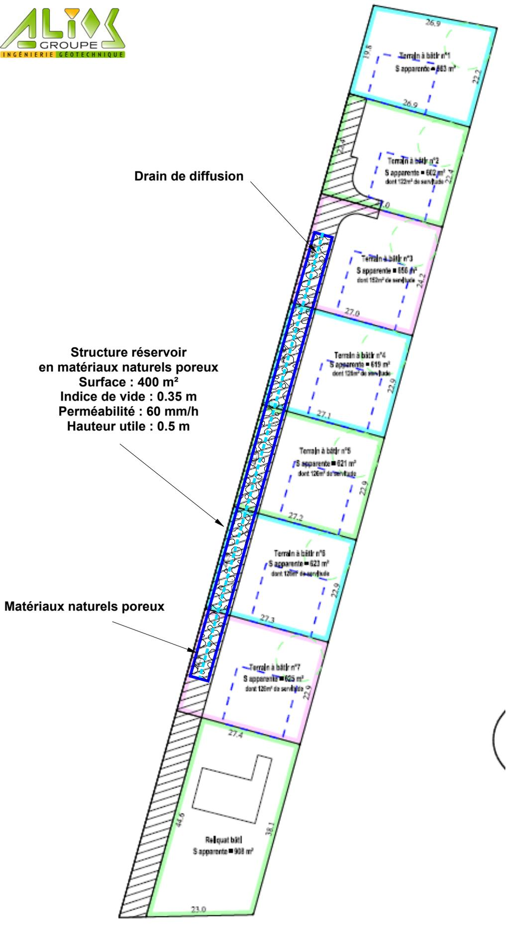
**SCHEMA DE PRINCIPE DE GESTION DES EAUX PLUVIALES**
